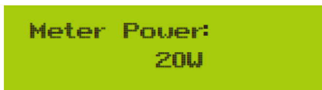
Функция нулевого экспорта при включении счетчика энергии
