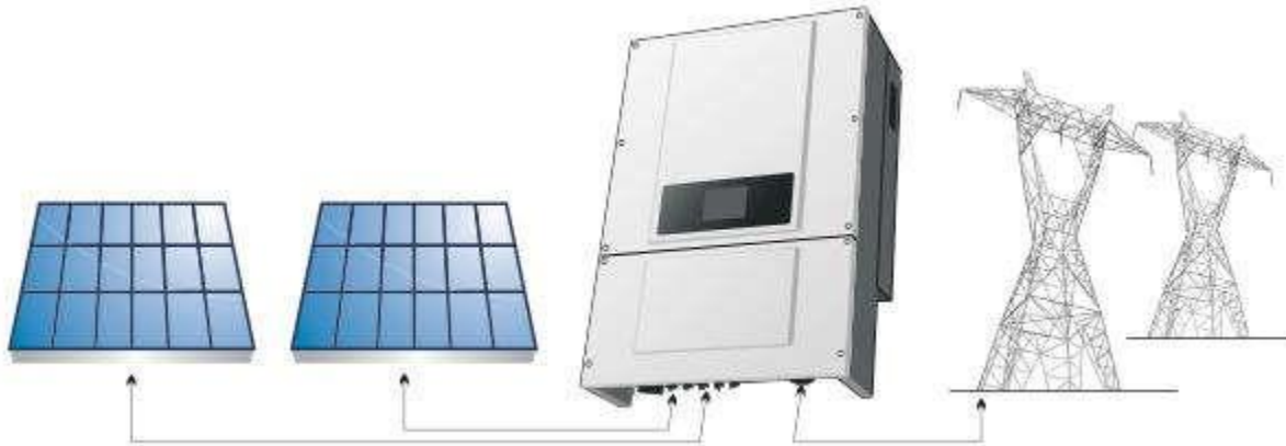
Рисунок 2-1 Фотоэлектрическая установка, связанная с электросетью
