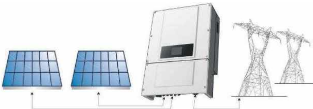
Рисунок 1 Сетевая солнечная электростанция
