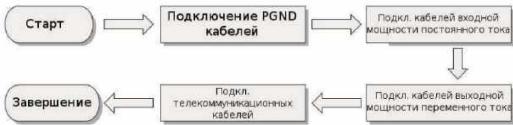
Рисунок 14 Блок-схема для подключения проводов к инвертору
