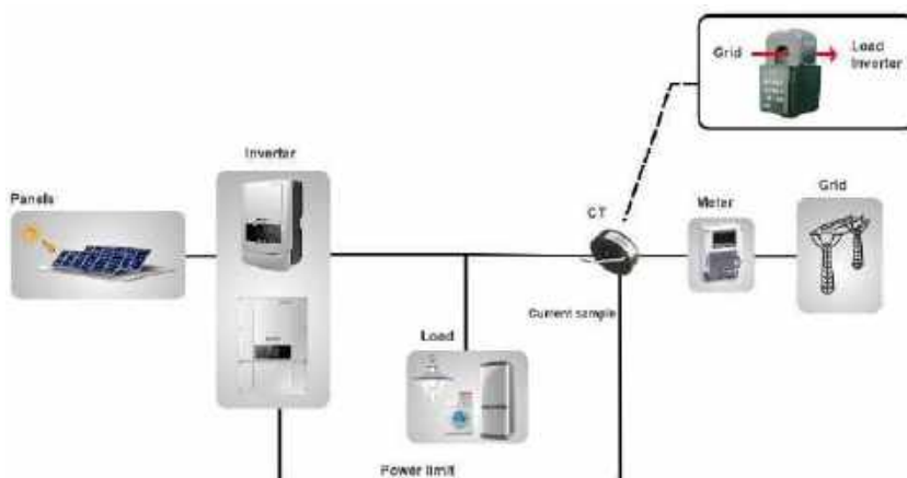
Рисунок 32 Расположение трансформатора тока в схеме электрохозяйства
