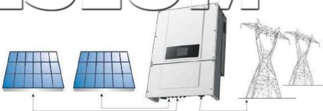
Рисунок 1 Сетевая солнечная электростанция
