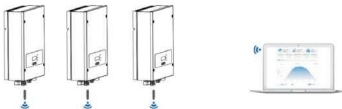
Рисунок 45 Подключение инверторов через Wi-Fi
