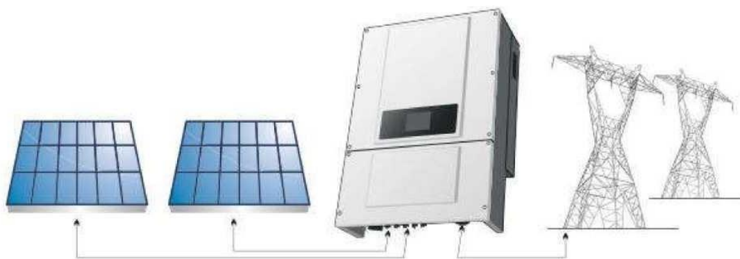
Рисунок 1 Сетевая солнечная электростанция
